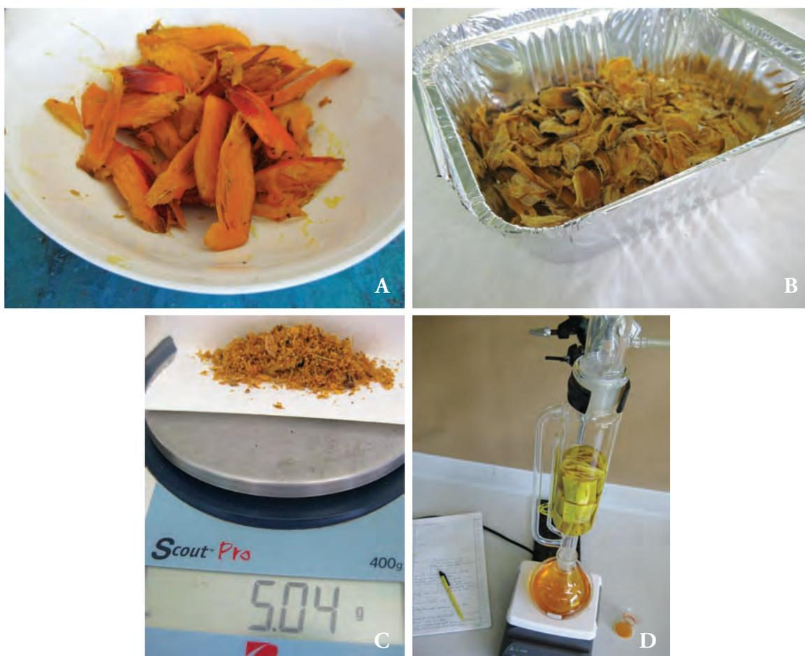
**Figura 3.14.** Determinación del aceite a mesocarpio. A: secado de mesocarpio fresco en horno microondas. B: mesocarpio seco en horno eléctrico. C: muestra de mesocarpio para extracción con solvente. D: extracción de aceite con sistema *Soxhlet*.
