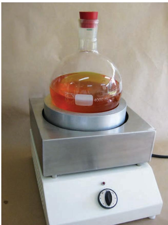
**Figura A.1.** Ejemplo de balón y plancha de calentamiento usado en sistema *Soxhlet* de múltiples muestras.
