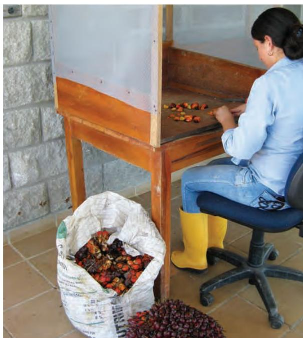
**Figura 1.3.** Ejemplo de mesón y cubículo de madera usados para el procedimiento de análisis de racimo.
