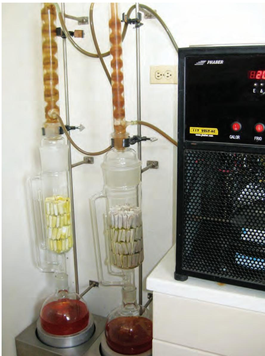
**Figura A.4.** Ejemplo de sistema *Soxhlet* de múltiples muestras con sistema de enfriamiento y recirculación de agua para los condensadores.
