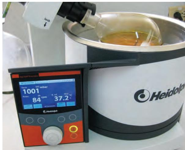
**Figura 3.48.** Rotoevaporador para la recuperación de hexano en la mezcla solvente-aceite.
