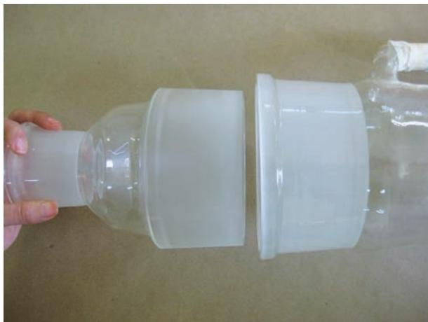
**Figura A.2.** Ejemplo de conexiones entre el cuerpo y el condensador del sistema *Soxhlet* de múltiples muestras.
