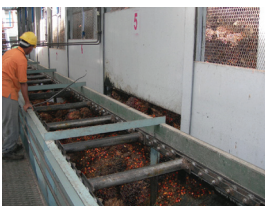
Redler alimentador de fruto en el sistema de esterilización continua
