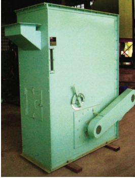
Separador neumático de mezcla triturada cuesco - almendra
