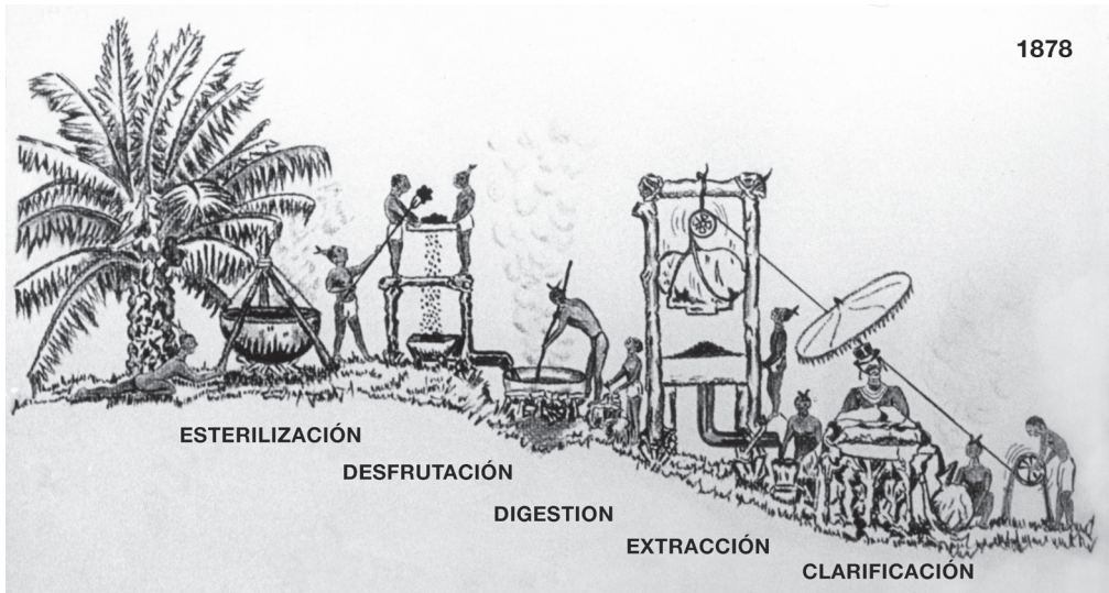
Proceso artesanal de extracción de aceite de palma
